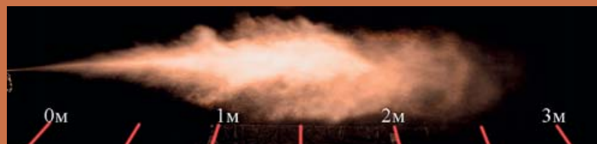
Аэрозольный тип распыления, расход 10 г/с, 65 мл (модели «Жгучий перчик», «Перцовка», «Перец 11-А»)
