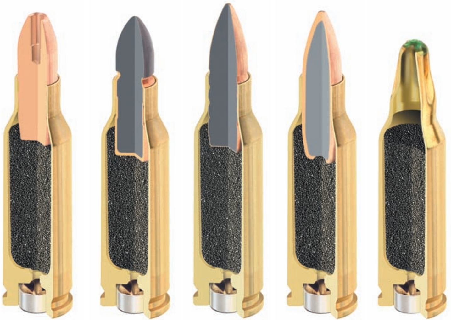
Патроны 4,6x30 в разрезе (слева направо): 4,6x30 патрон SINTOX® Action с экспансивной пулей; 4,6x30 патрон SINTOX® Penetrator с пулей повышенной пробивной способности; 4,6x30 патрон SINTOX® Steel Monolith с пулей со стальным сердечником; 4,6x30 патрон SINTOX® Ball с оболочечной пулей; холостой патрон 4,6x30 SINTOX® Blank (DM18). Фото RUAG Ammotec
