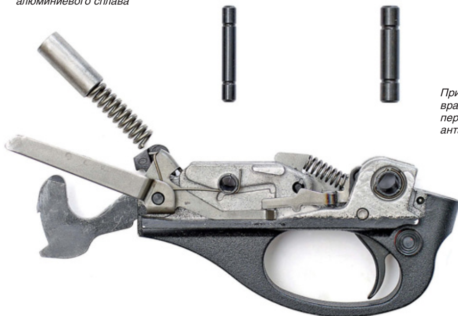
УСМ карабина незамысловат и собран из штампованных деталей на литом основании из алюминиевого сплава
