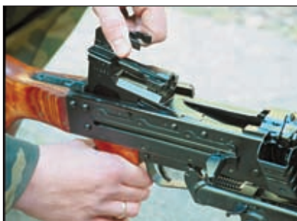
Извлечение затворной рамы из ствольной коробки
