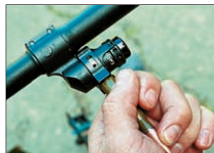
Переключение установок газового регулятора осуществляется с помощью патрона или гильзы
