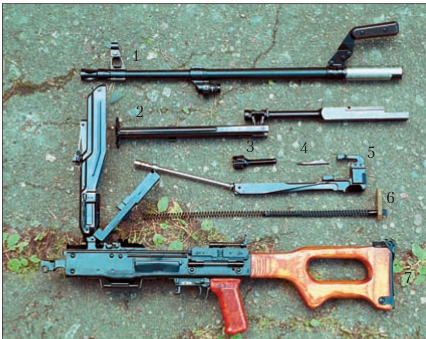
Вид пулемёта ПКМ при неполной разборке.
