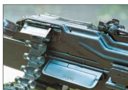
Ленто- и гильзовыводные окна закрыты подпружиненными пилезащитными щитками
