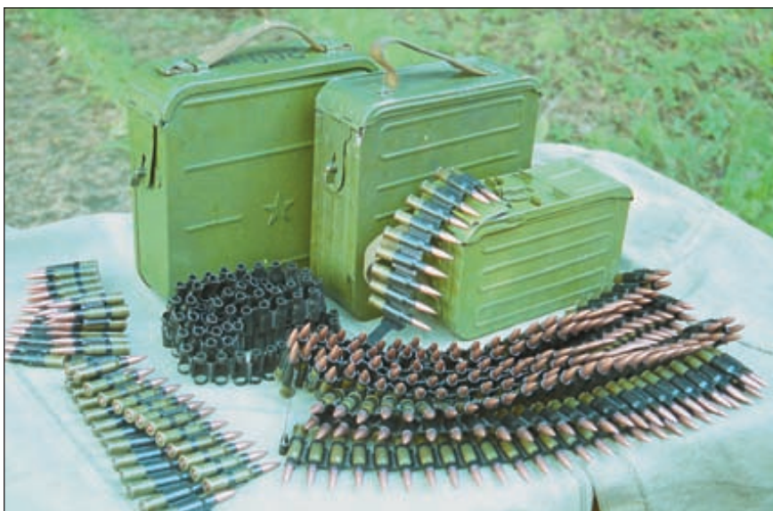
Для стрельбы из ПК/ПКМ используются как штатные ленты, так и кусковые (по 25 патронов) ленты пулемёта ПКТ (танкового). На фото слева
