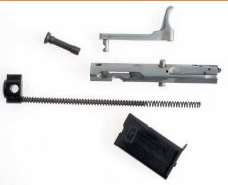
Автоматику «Коршуна» нельзя назвать сложной. Для осмотра, чистки и смазки механизм разбирается без применения инструмента
