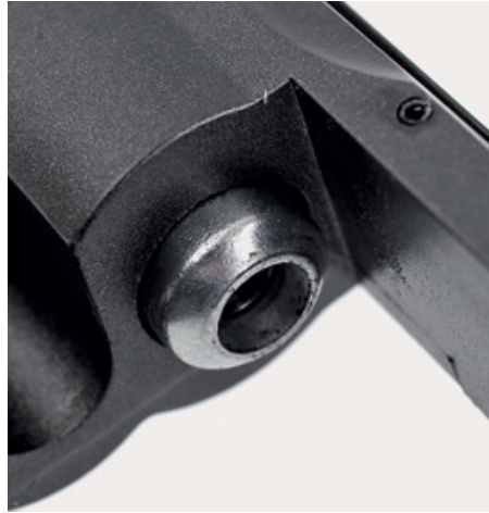
Блестящая подпружиненная деталь – элемент обеспечения соосности барабана и канала ствола
