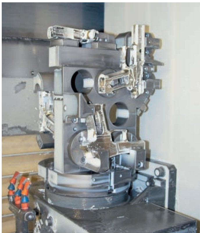
Немецкий станок с программным управлением за один раз обрабатывает 4 заготовки
