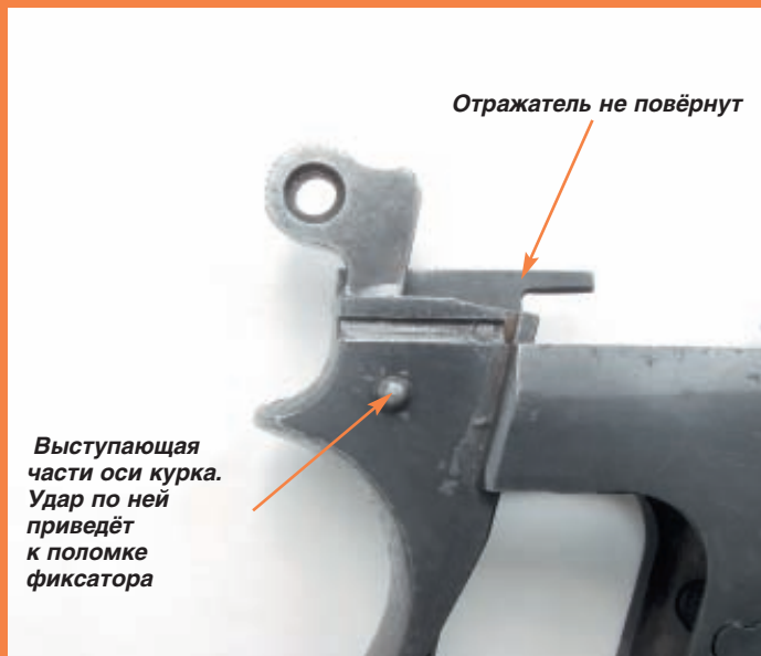
Ил. 35. Положение деталей при разборке, приведшее к поломке на ил. 33
