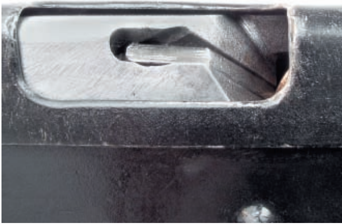
Ил. 48. ПП-71. Подвижные части не дошли в КПП. Визуально обнаружить причину задержки практически невозможно
