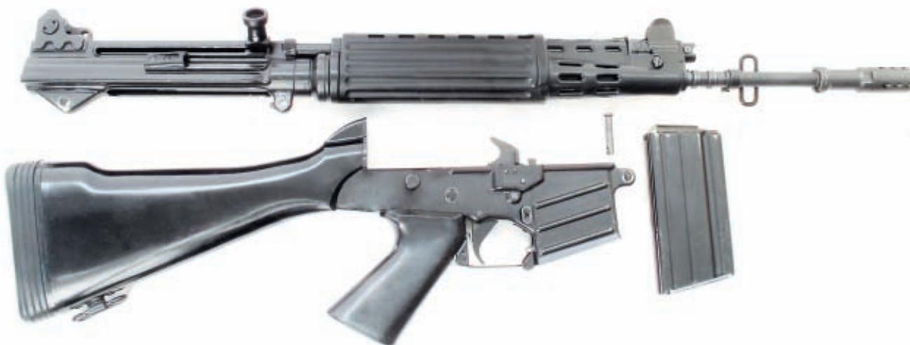
Ил. 36. Первый этап неполной разборки FN-CAL. Обнаружить возвратный механизм не удаётся
