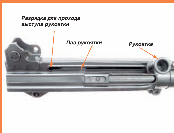
Ил. 38. Определение возможности отделения рукоятки
