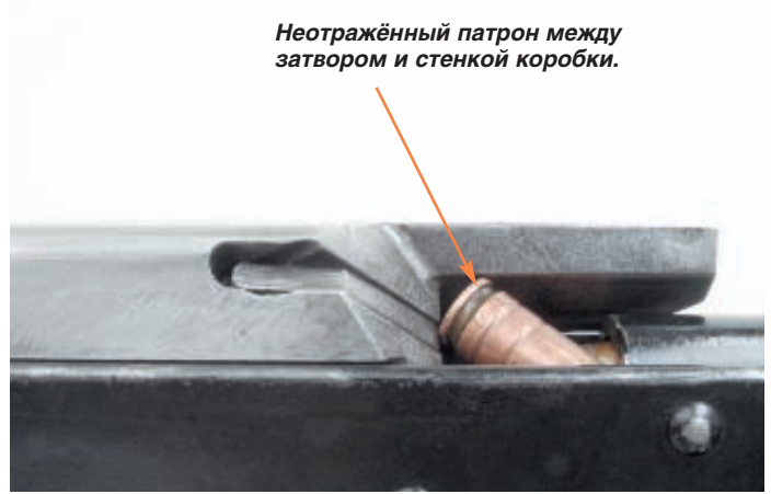
Ил. 49. ПП-71 со снятой крышкой. Задержка
