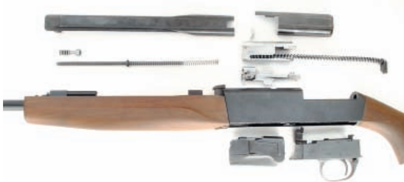
Ил. 44. Неполная разборка «Изюбрь»
