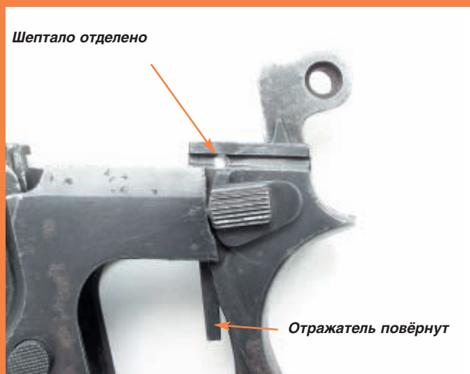
Ил. 32. Положение отражателя для отделения оси курка
