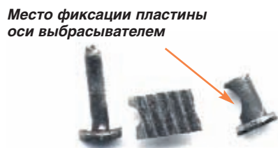
Ил. 31. Ломка пластины оси спускового рычага
