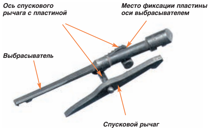
Ил. 30. Способ фиксации оси спускового рычага выбрасывателем
