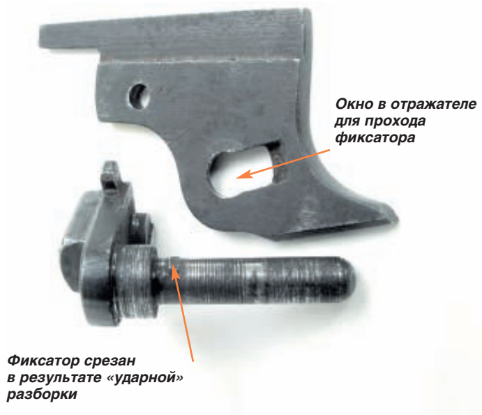
Ил. 33. Способ фиксации и поломка фиксатора оси курка
