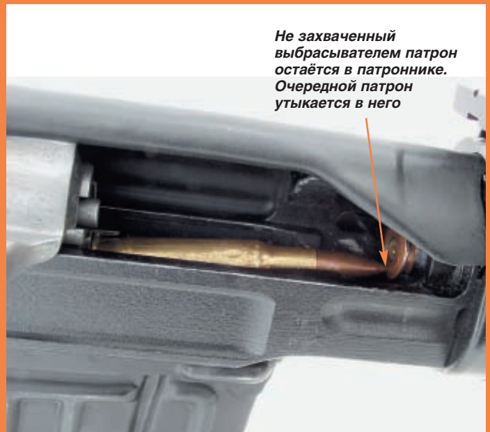
Ил. 51. Задержка при попытке устранить ситуацию на ил. 50 передёргиванием затвора.
