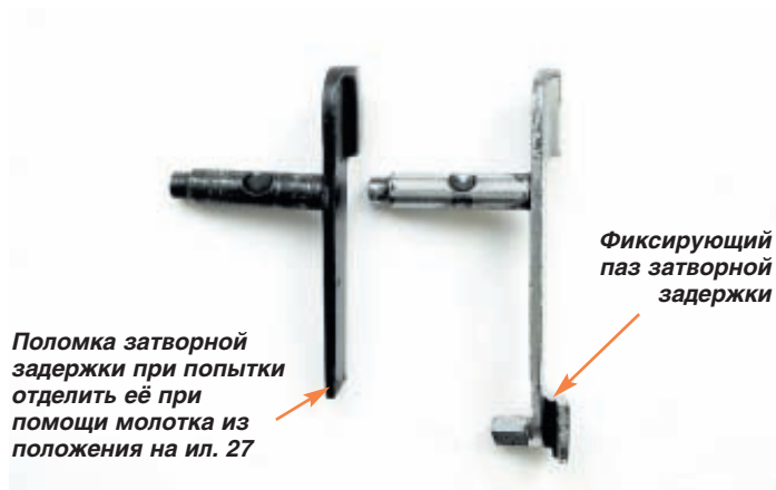
Ил. 29. Способ фиксации затворной задержки и её ломка
