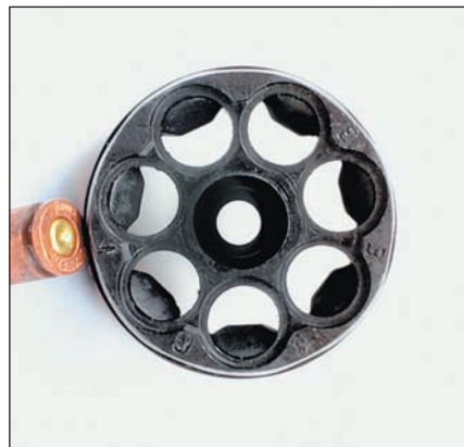
Вид спереди на доработанный барабан травматического «Нагана». Хорошо видны вставки в камерах
