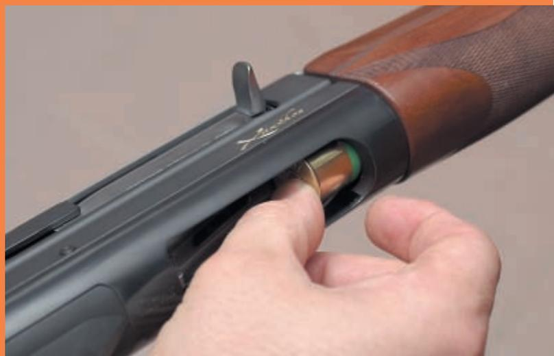
*При снаряжении магазина не нужно каждый раз отдельно утапливать подаватель. Если патрон укладывать в основание подавателя, то он своим цоколем отжимает замыкатель и подаватель поднимается, освобождая путь в магазин*
