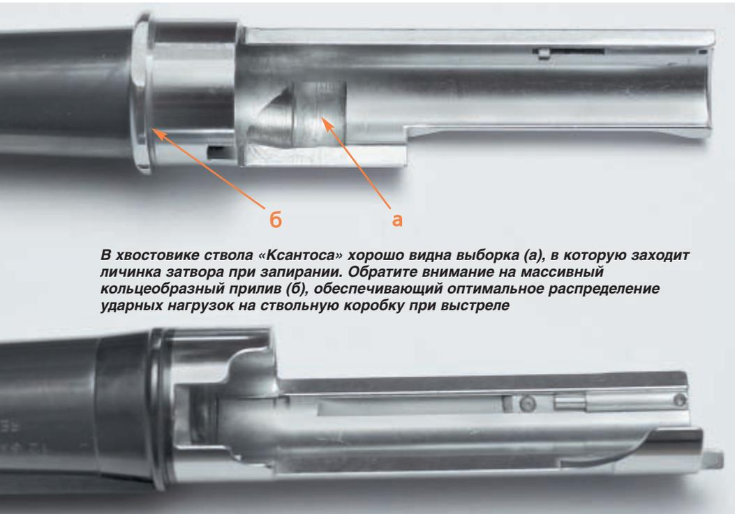
*В хвостовике ствола «Ксантоса» хорошо видна выборка (а), в которую заходит личинка затвора при запираении. Обратите внимание на массивный кольцеобразный прилив (б), обеспечивающий оптимальное распределение ударных нагрузок на ствольную коробку при выстреле*
