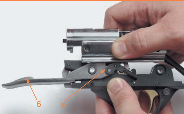
Если ружьё неподвижно, то при отведении затворной рамы назад подпружиненный рычаг подавателя (а) просто поворачивается на оси и подаватель (б) остаётся неподвижным
