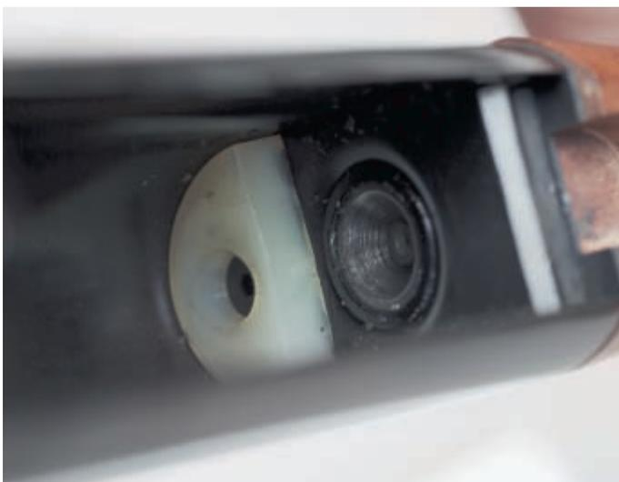
Внутри ствольной коробки «Ксантоса» имеется полиуретановый демпфер, принимающий на себя удар затворной рамы в крайнем заднем положении и делающий стрельбу из ружья более комфортной
