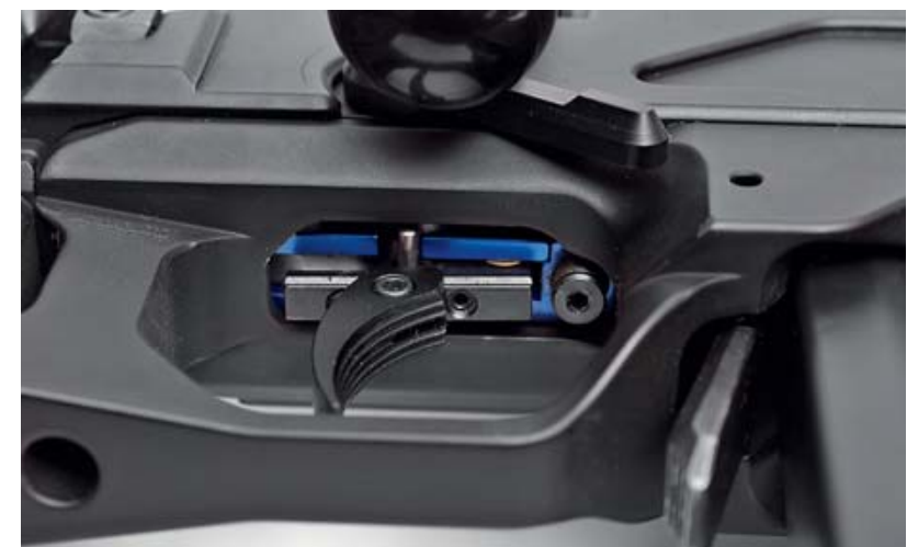
Спусковые механизмы обеих винтовок регулируемые, с заводской установкой около 1,5 кг. Оба спусковых крючка имеют возможность перемещаться по длине, что особенно важно для «Хайнеля» с довольно «худой» рукояткой управления огнём
