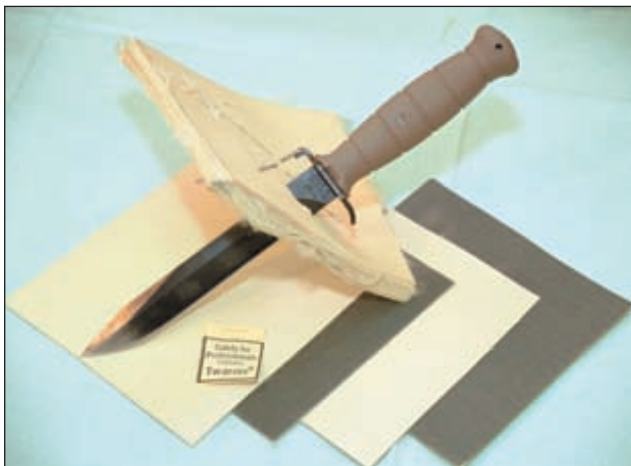
Новый материал SRM, который представляет из себя полотно тварона, покрытое слоем особо прочного корундового покрытия
