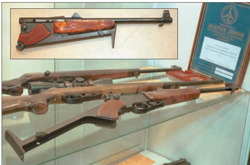
Витрина стенда Тульского оружейного завода. На врезке компактный самозарядный малокалиберный карабин ТОЗ-199 со сложенным прикладом
