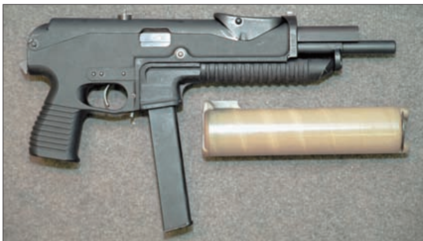
Очень приятное впечатление оставил новый пистолет-пулемёт Тульского конструкторского бюро приборостроения ПП90М1. Пистолет-пулемёт позволяет использовать шнековые (роторные) и коробчатые магазины
