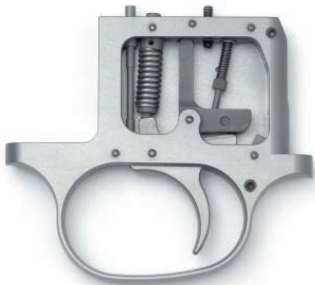
Ударно-спусковой механизм Strasser RS 05 смонтирован в отдельном основании и позволяет осуществлять дискретную регулировку усилия спуска (0,8; 1,6 и 2,5 кг) без применения инструмента
