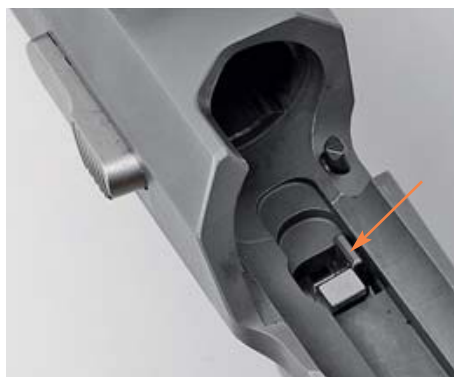
Стрелкой указан выступ рычага предохранителя, который во включенном положении выступает из ствольной коробки чуть впереди боевого взвода шептала и работает как перехватыватель
