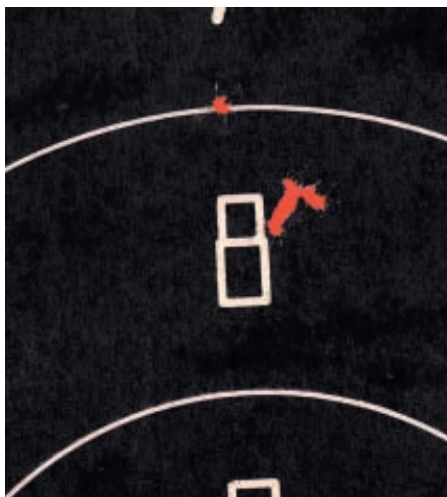
Патрон Norma Swift A-frame, поперечник рассеивания 32 мм. Масштаб 1:2
