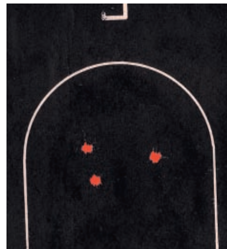
Патрон S&B HPBT, поперечник рассеивания 34 мм. Масштаб 1:2
