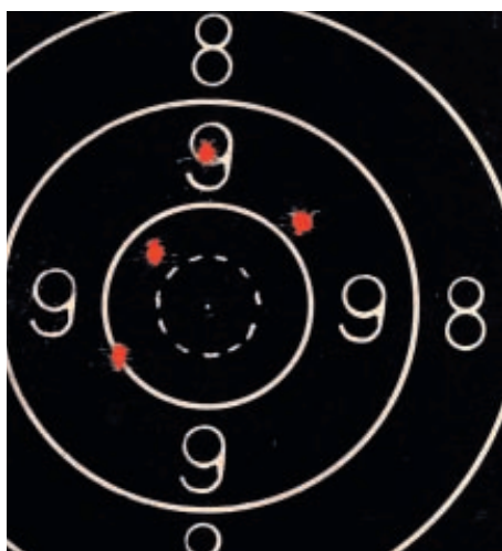
Патрон Norma Alaska, поперечник рассеивания 53 мм. Масштаб 1:2
