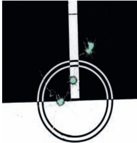
Патрон БПЗ, оболочечная пуля, поперечник рассеивания 55 мм. Масштаб 1:2
