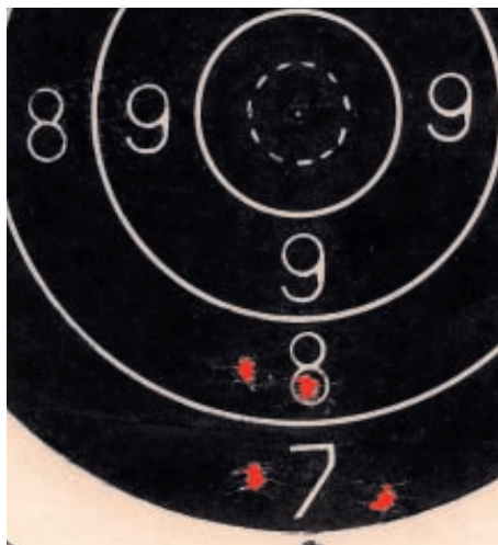
Патрон Blaser CDP, поперечник рассеивания 45 мм. Масштаб 1:2
