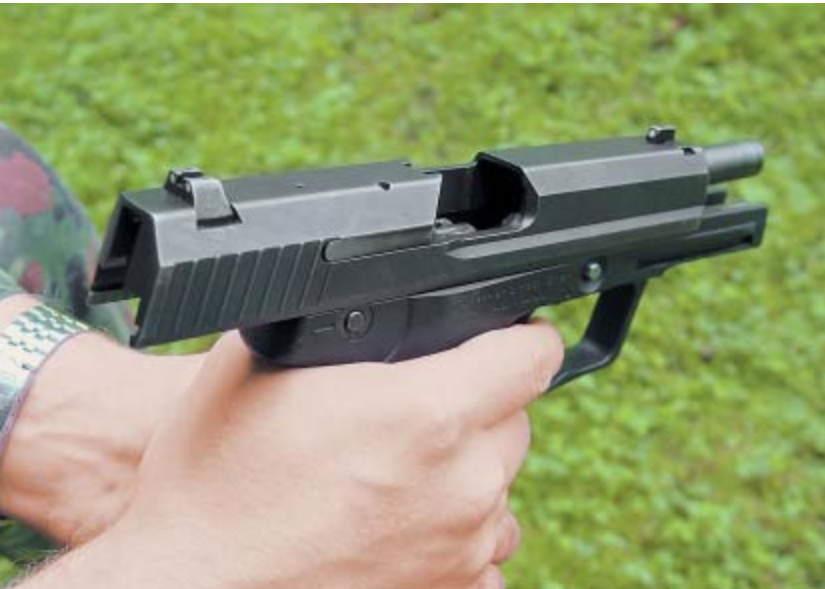
Затвор пистолета на затворной задержке. Хорошо виден прицел с тремя контрастными белыми точками
