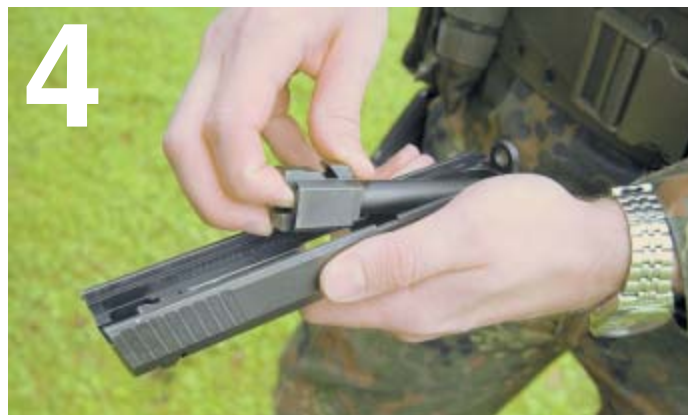
Последний шаг полевой разборки – отделить ствол
