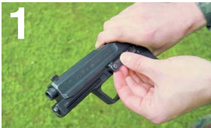
Порядок неполной разборки пистолета. Отведя затвор чуть назад, извлечь затворную задержку
