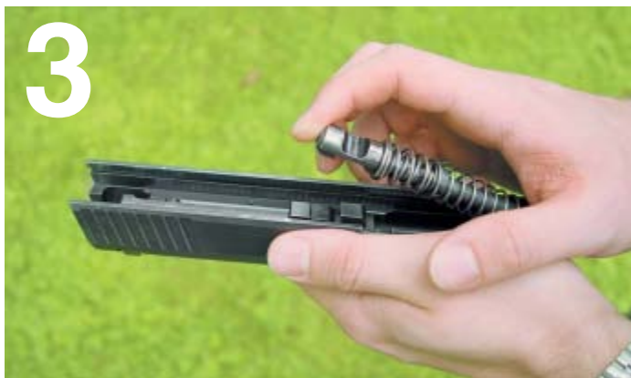
Отделить возвратную пружину с её направляющей
