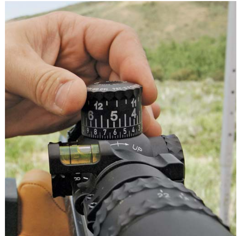
Прецизионный барабанчик вертикального наведения G7 со шкалами, проградуированными в ярдах и в угловых минутах, даёт быстрый и лёгкий способ правильно выбрать точку прицеливания для стрельбы на большие дистанции
