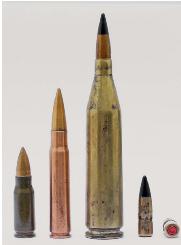
7,92-мм патроны германской армии, 7,92x33 (Pist. Patr. 43), 7,92x57 (Mauser), 7,92x94 (Patr. 318), пуля SmKH-Rs-L'spur и её донная часть (под красным целлюлоидным колпачком расположен трассер, за которым в углублении сердечника размещено ОВ). При разрядке патронов по прошествии 70 лет с момента производства сразу ощущаешь легкое пощипывание в носу (хлорацетофенон за это время просочился через трассер)
