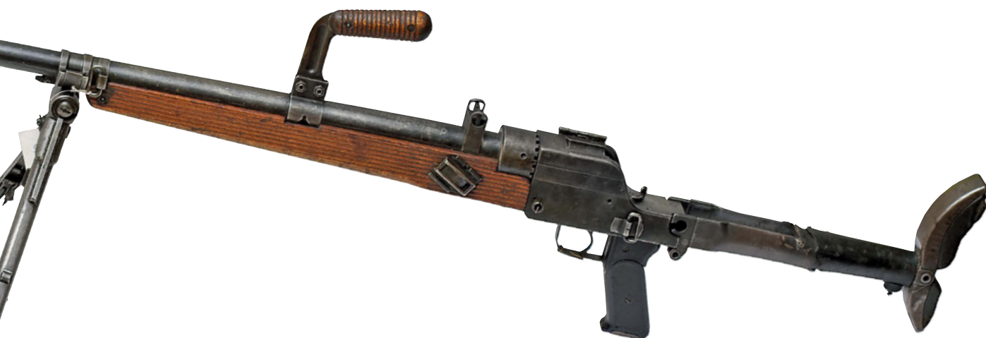
7,92-мм ПТР PzB 39 в боевом положении (магазины-ускорители заряжания отсутствуют). Для уменьшения отдачи ствол оснащён мощным дульным тормозом, а затыльник приклада амортизатором. Сошка с изменяемой высотой линии огня заимствована от MG 34
