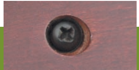
Передние ложевые винты вворачиваются в торец воздушного цилиндра под углом к горизонту
