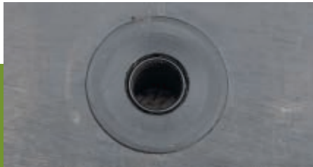
Антифрикционная шайба в углублении муфты ствола
