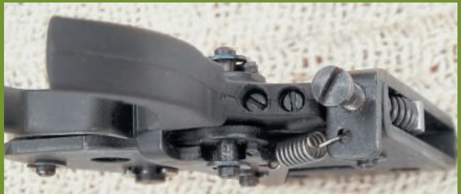
Регулировочные винты спускового механизма: справа винт регулировки усилия спуска, в пластиковом спусковом крючке хорошо видны винты регулировки его хода
