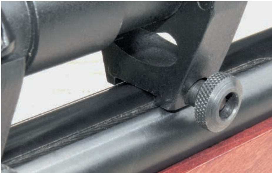
Установить на West оптический прицел можно только с помощью кронштейнов, имеющих острые кромки захватов
