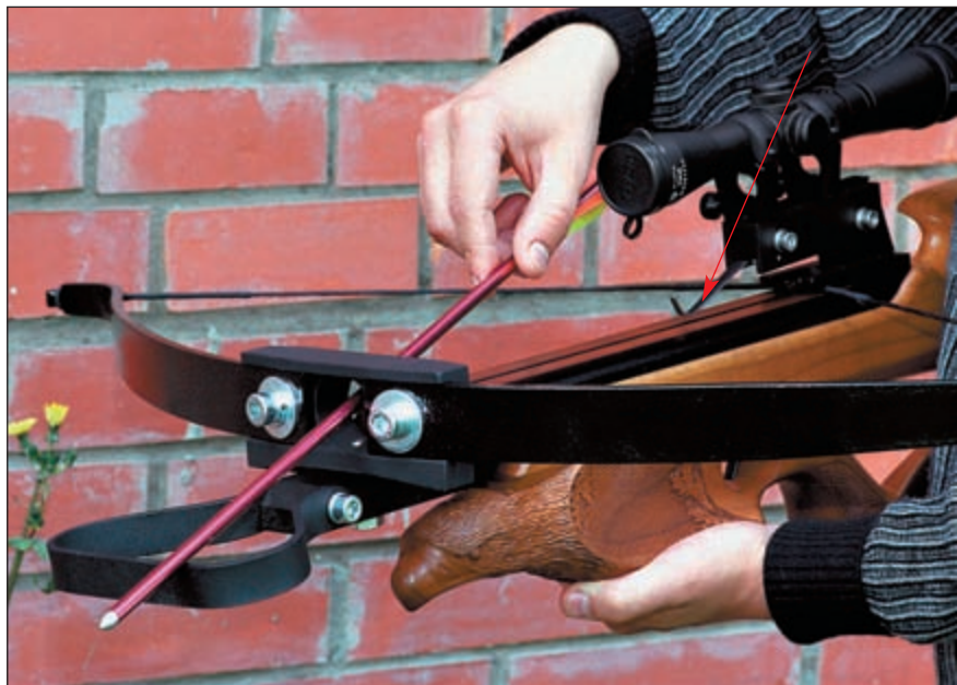
Заряжание арбалета стрелой. Заряженная стрела удерживается специальной пластинчатой пружиной (указана стрелкой)
