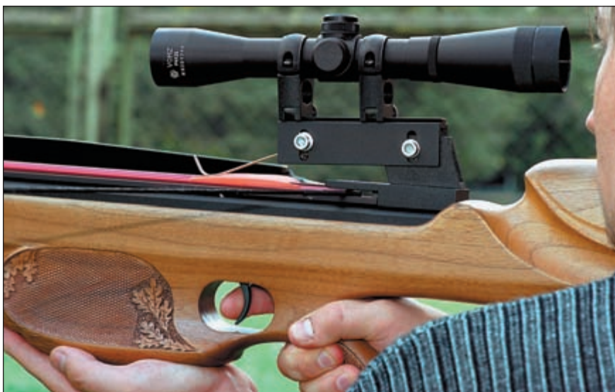
Регулируемый кронштейн оптического прицела позволяет пристрелять прицел арбалета с плечами различной мощности
