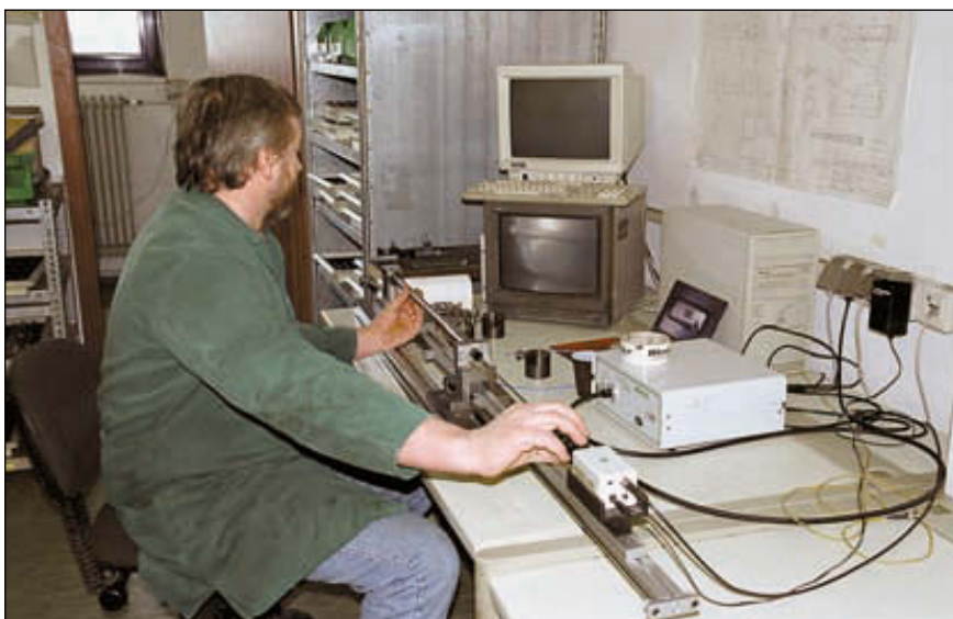
Проверка качества обработки каналов стволов при помощи лазерной установки
