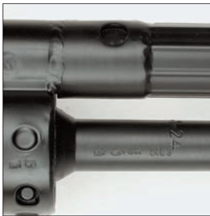
Казённая часть ствола VT 96 с испытательным клеймом ФРГ. На стволе маркировка изготовителя – МКЕ 1-24. На BWT 5 (внизу) рядом с австрийским испытательным клеймом также обнаруживается маркировка МКЕ 1-24. Стволы имеют общего изготовителя
