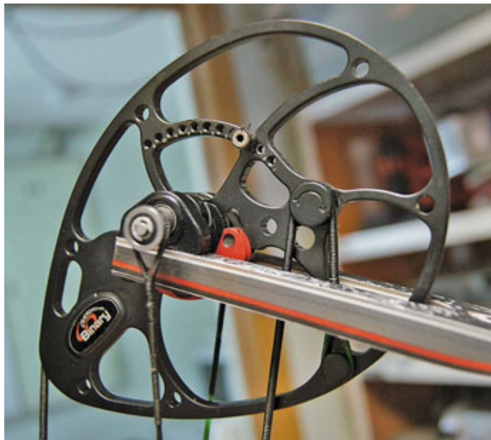
Новые, более прочные эксцентрики на BowTech Destroyer 350
