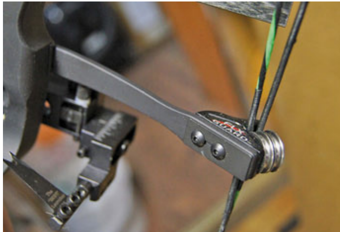
Новая гибкая отводящая из стеклопластика, позволяющая тросам в момент выстрела отодвигаться в сторону, а потом возвращаться обратно, не задевая стрелу
