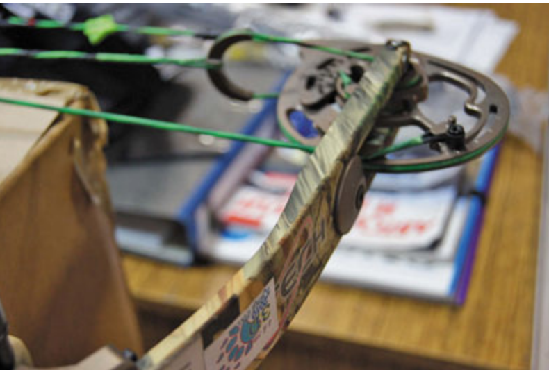
Толстые, но однослойные плечи из стеклопластика иногда подводили
