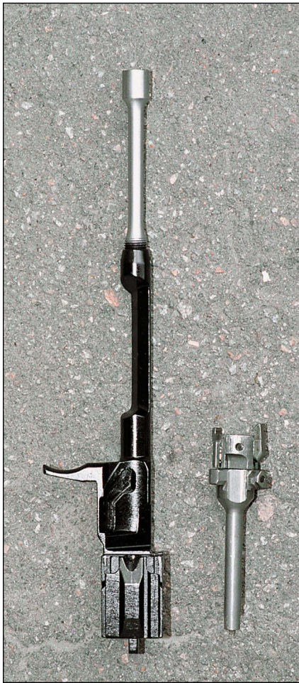
Затворная рама с поршнем и поворотный затвор – фирменные черты, унаследованные «Сайгой» от автомата Калашникова
