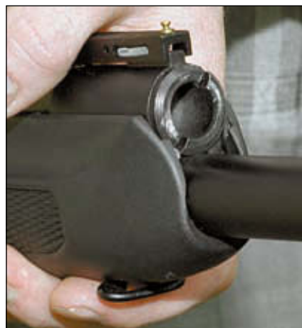
Двухпозиционный регулятор газового двигателя «Сайги-12» обеспечивает одинаковую надёжность работы автоматики при стрельбе обычным патроном 12-го калибра (12x70) и «магнумом» (12x76)
