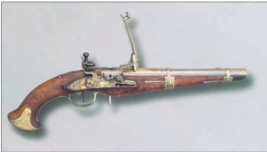
Кремневый казнозарядный пистолет, Санкт-Петербург, 1780–1785 гг. Мастер Гаврила Пермяков. При поднятии крышки (на фото) открывалась зарядная камера
