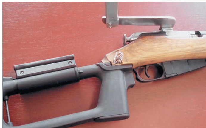
Модернизированный вариант устройства с подпружиненной скобой
