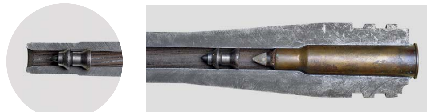
Дульная и казённая части канала ствола sPzB-41 с вложенным нестрелянным бронейным снарядом. Явно видна заметная конусность ствола
