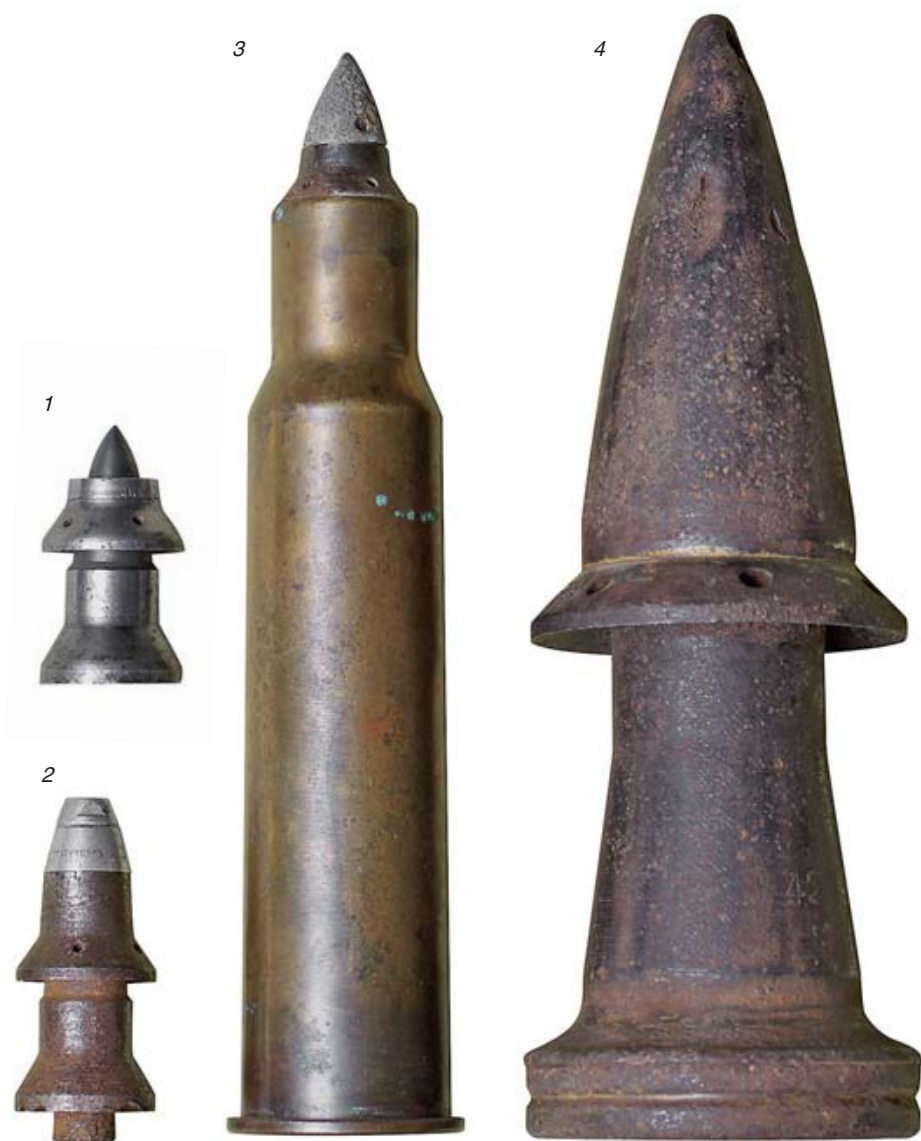
1,2 – бронебойный и осколочный снаряды, 3 – унитарный патрон с бронебойным снарядом (sPzB-41), 4 – 75/55-мм сплошной снаряд (Pak 41)
