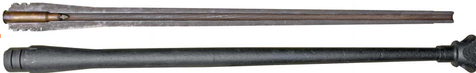
Ствол sPzB-41 и его продольный разрез
