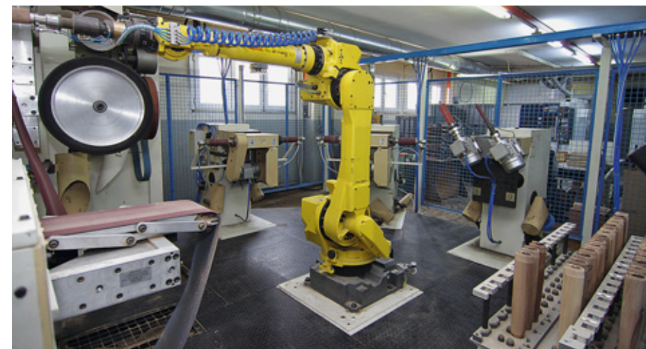
Очень скоро шестерых работников шлифовального участка в деревообрабатывающем цеху заменит один роботизированный комплекс (на фото), а мастера будут перучены на другие специальности
