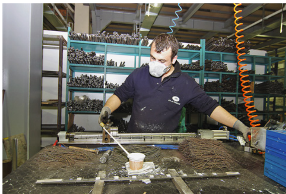
Перед загрузкой в печь, прицельная планка после нанесения припоя и флюса увязывается со стволами проволочными хомутами
