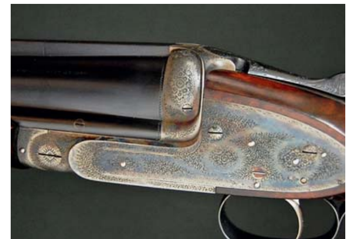
Одностволка Пёрдэ с 7-пиновым самооткрывающимся замком
