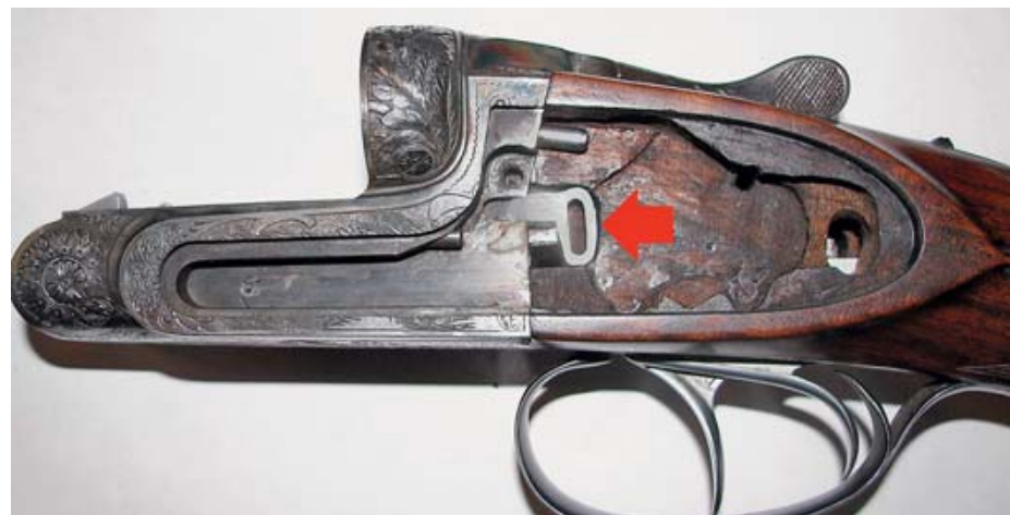
Эжектор и его привод (красная стрелка) ружья МЦ11 выпуска 1976 г
