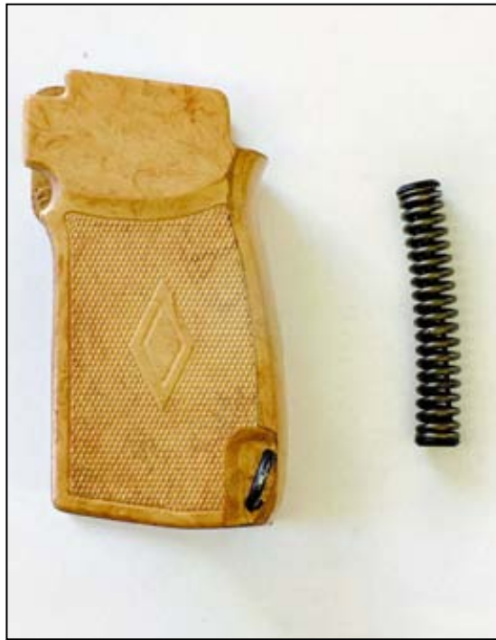
Рукоятка с возвратным механизмом (справа возвратный механизм извлечён из рукоятки)
