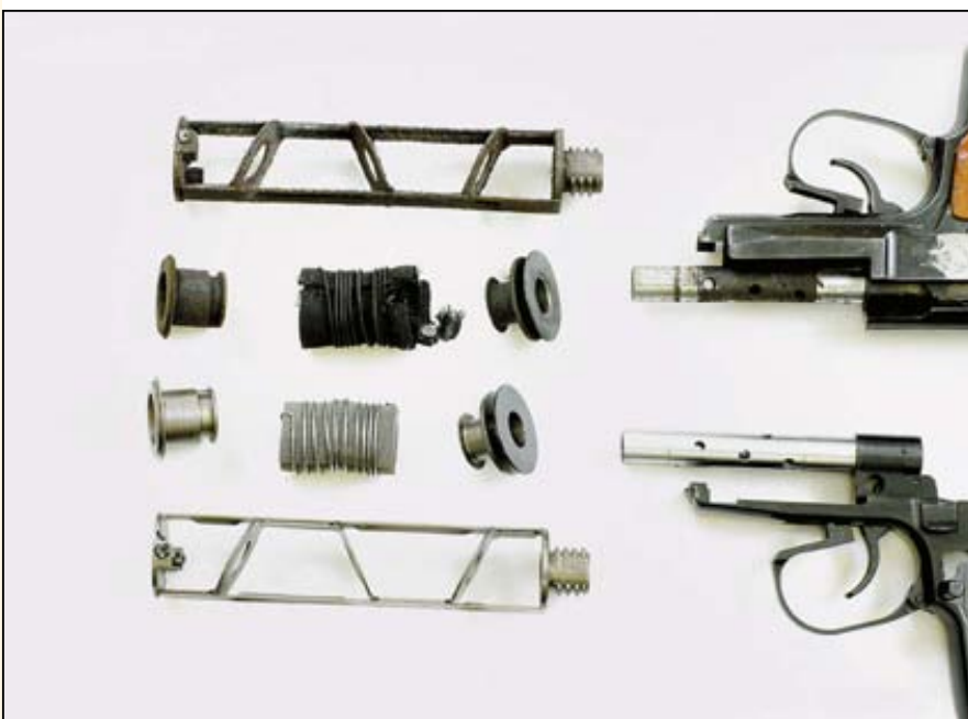
Детали нового пистолета (внизу) и пистолета, имеющего настрел 4500 выстрелов со сроком эксплуатации около 10 лет при не очень регулярном уходе. Последний после стрельбы не чищен, на деталях виден густой нагар. Сетчатый рулон деформирован и повреждён. Хромовое покрытие средней части ствола практически отсутствует
