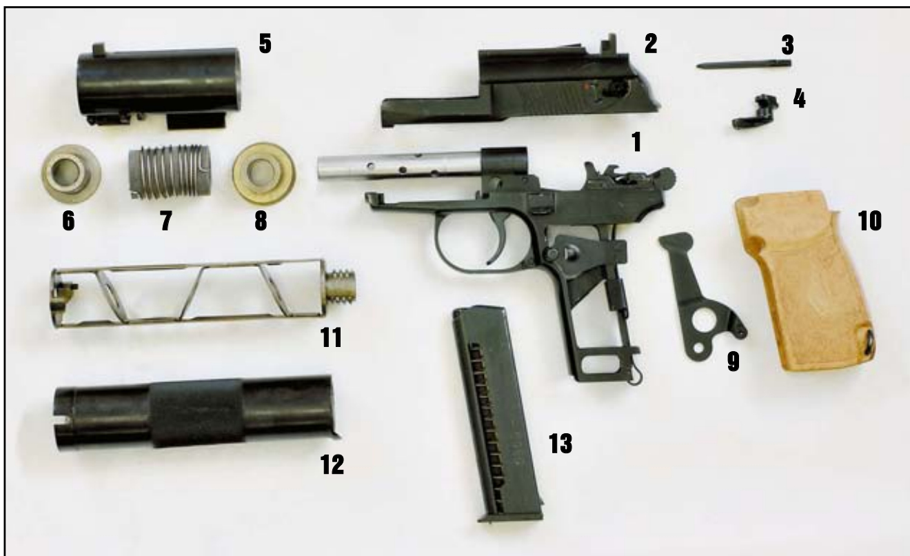
1 – рамка со стволом и УСМ, 2 – затвор, 3 – ударник, 4 – предохранитель, 5 – расширительная камера, 6 – передняя втулка, 7 – сетчатый рулон, 8 – задняя втулка, 9 – передаточный рычаг, 10 – рукоятка, 11 – сепаратор, 12 – корпус насадка, 13 – магазин
