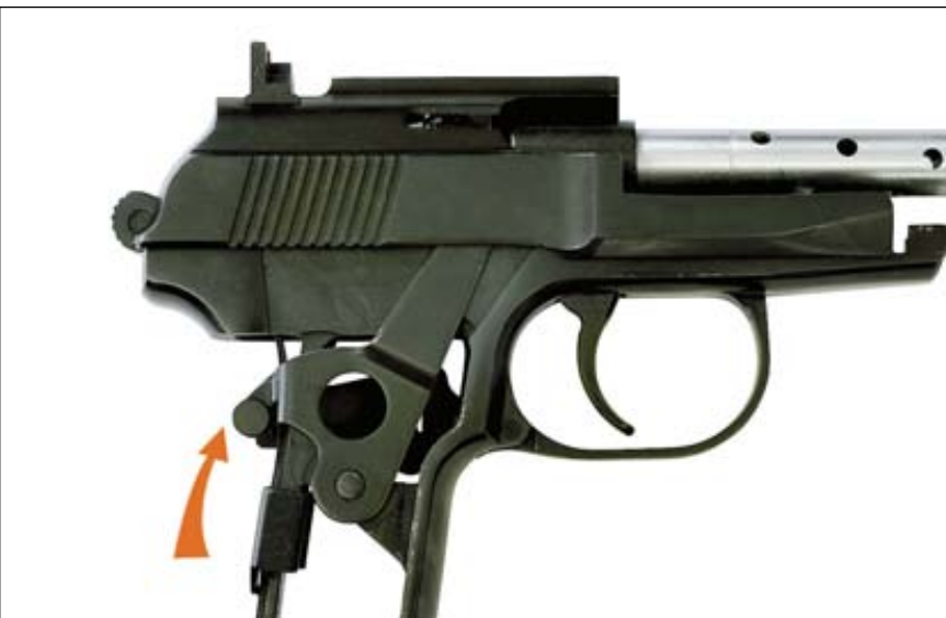
Работа передаточного рычага при откате (вверху) и накате затвора
