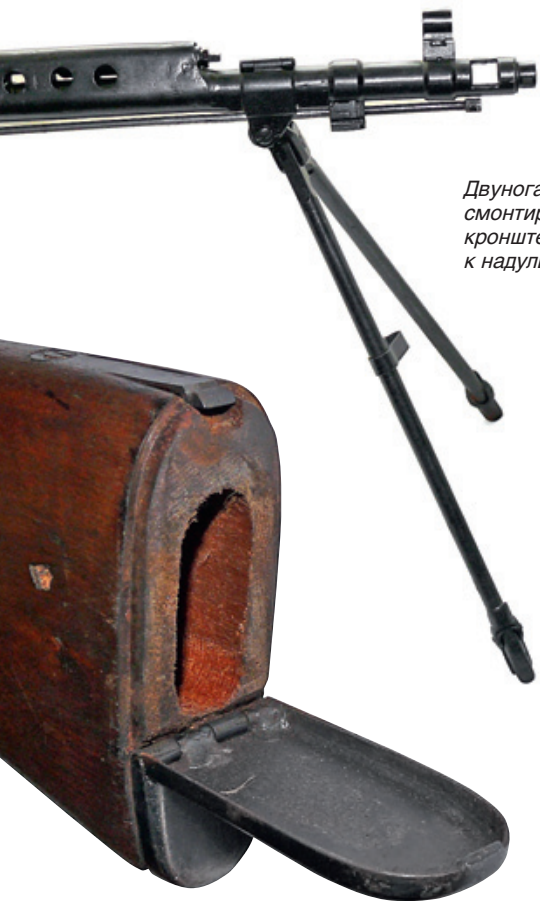
Продольный канал в прикладе предназначался для хранения шомпола и принадлежности
