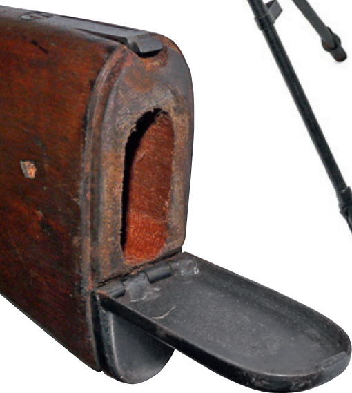
Продольный канал в прикладе предназначался для хранения шомпола и принадлежности
