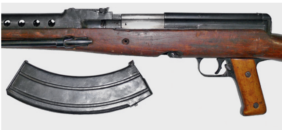
Двухрядный секторный магазин крепился на автомате при помощи зацепа впереди и подпружиненной защёлкой сзади
