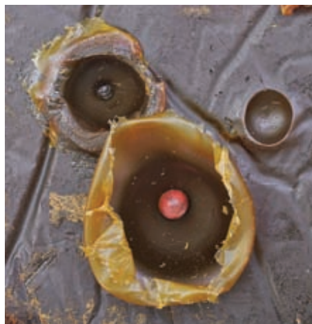
При стрельбе по петролатуму 45-й «Лидер» и типичная «девятка» (левее-выше) дают заметно разный результат
