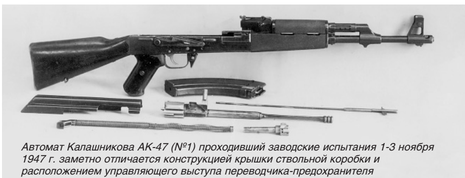
Части неполной разборки автомата Калашникова
