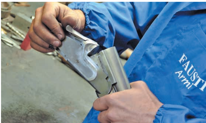
Контроль плавности открывания ружья, оснащённого системой запирания Four Locks. Также проверяется соответствие угла поворота верхнего ключа плотности вхождения запорной рамки в вырезы на подствольных крюках
