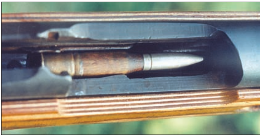
Учебный патрон образца ОСШ 1896/09 гг. в приёмнике винтовки
