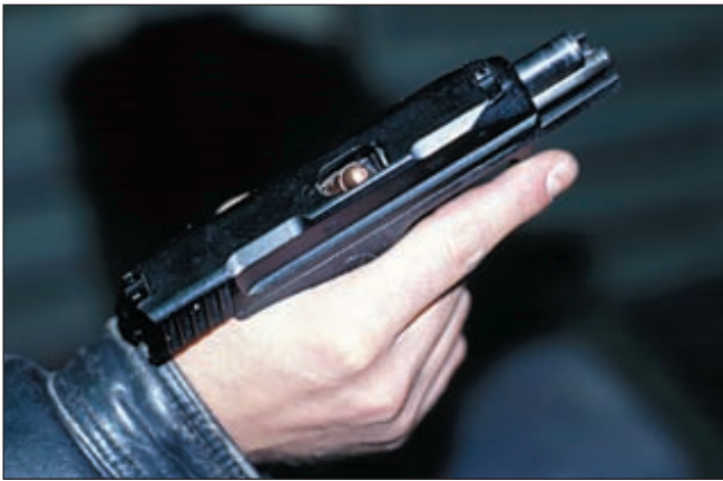
При недостаточно энергичном отведении затвора в крайнее заднее положение возможно возникновение одной из самых распространённых в пистолетах задержек – перекося патрона при досылании его из магазина в патронник
