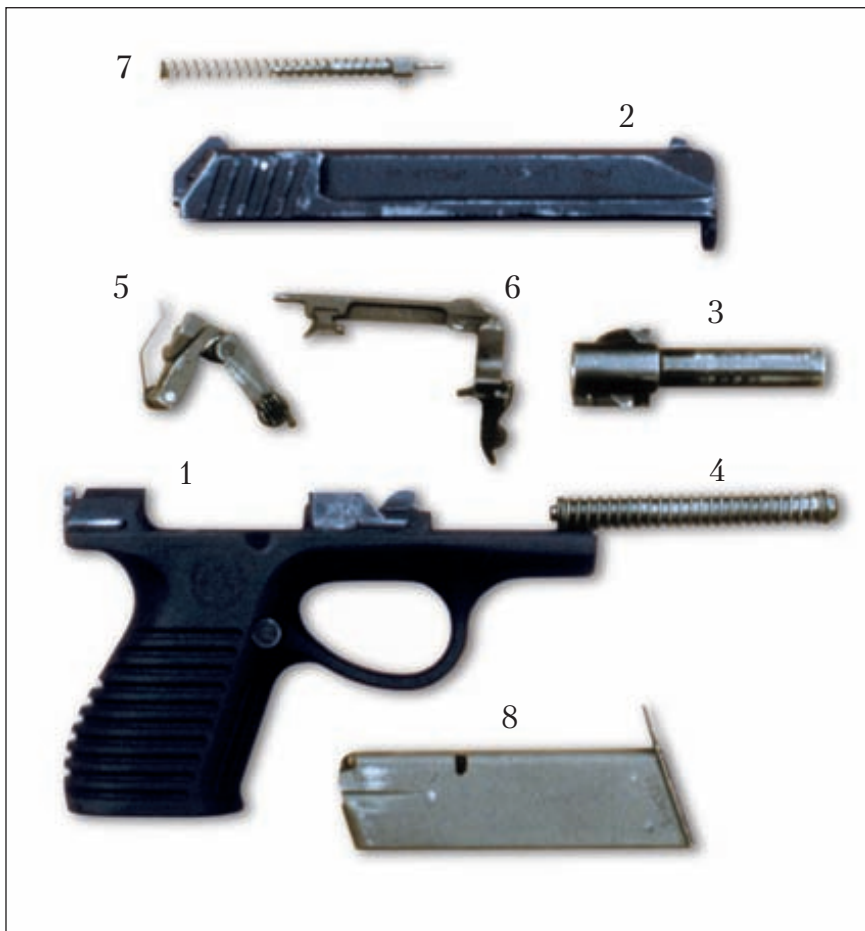
П-96. Неполная разборка 1 – рамка; 2 – затвор; 3 – ствол; 4 – возвратный механизм; 5 – спусковой механизм; 6 – спусковой крючок с тягой и шепталом; 7 – ударник с боевой пружиной; 8 – магазин
