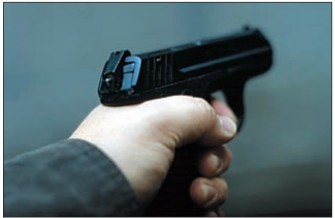
По паспорту, прилагаемому к пистолету, «задняя часть бойка (ударника), выступающая на 1 мм за габарит пистолета, указывает на наличие патрона в патроннике или на взведенное положение частей пистолета»
