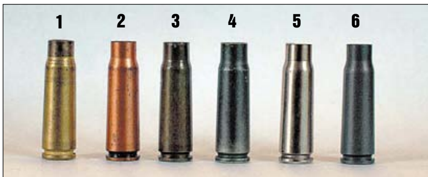
Гильзы патронов обр. 43 г. 1 – ГЖ (сталь лакированная латуною); 2 – ГЖ (сталь лакированная томпаком); 3 – ГС (стальная лакированная); 4 – опытная алюминиевая; 5 – стальная никелированная (коммерческая); 6 – стальная с полимерным покрытием.
