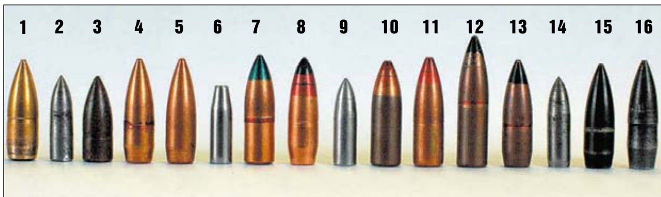
1,2 – пуля и сердечник Pist. Patr. 43 м.Е.; 3 – пуля патрона 7,62x41, 4,5,6 – пули ПС (5 – вариант без накатки – каннелюры) и сердечник, 7 – пуля Т-45; 8,9 – пуля БЗ и сердечник; 10,11 – пуля З; 12 – пуля УС; 13,14 – пуля БП и сердечник; 15 – пуля ПС производства ГАР со стальной лакированной оболочкой; 16 – сплошная стальная пуля производства ГАР
