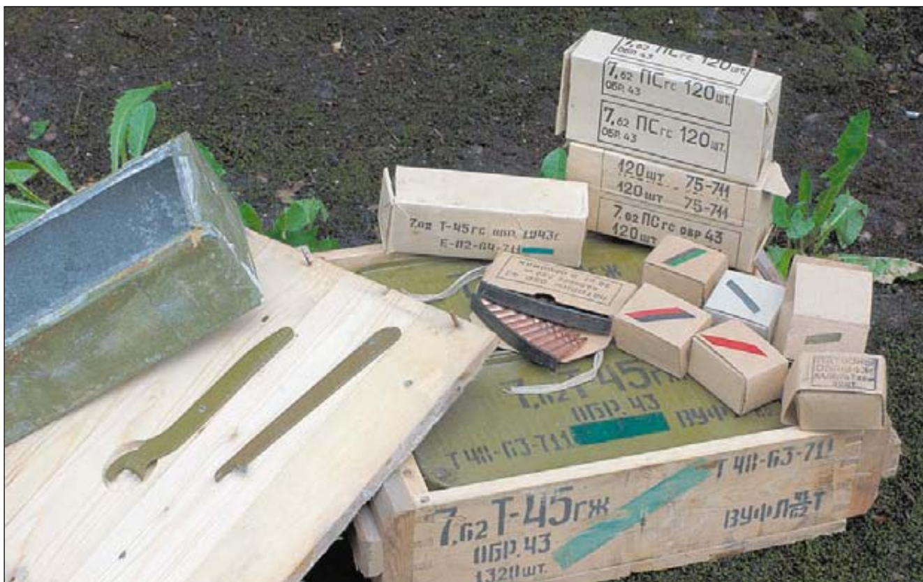
Упаковка патронов обр. 43 г.: штампозакатанная металлическая коробка (в ящике), слева паяная металлическая коробка, изготовленная из оцинкованного железа (разговорное – «цинка») 50-х годов изготовления, ключи для вскрытия штампозакатанных коробок (на крышке), слева более ранний вариант, на заднем плане три варианта влагонепроницаемых пакетов (упаковываются без металлических коробок)
