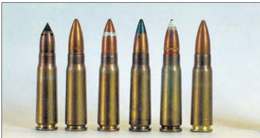
7,62-мм патроны обр. 43 г. с латунными гильзами производства Финляндии (VPT и Sako) и Чехословакии (крайний справа). Обращает на себя внимание патрон с оголённым бронебойным сердечником (слева). Подобная конструкция пули была забракована при создании пули БЗ из-за чрезмерного износа трактоов подачи патронов оружия, был введён латунный колпачок
