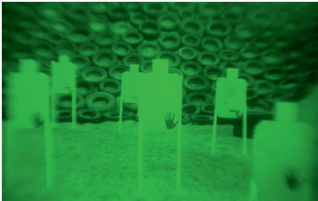
На самом деле изображение, наблюдаемое глазом в ночной прибор или прицел высокого класса (в данном случае «Дедал-370»), существенно лучше. Искажения и размытия на фото являются следствием невозможности идеально согласовать ночной модуль с имеющимся объективом
