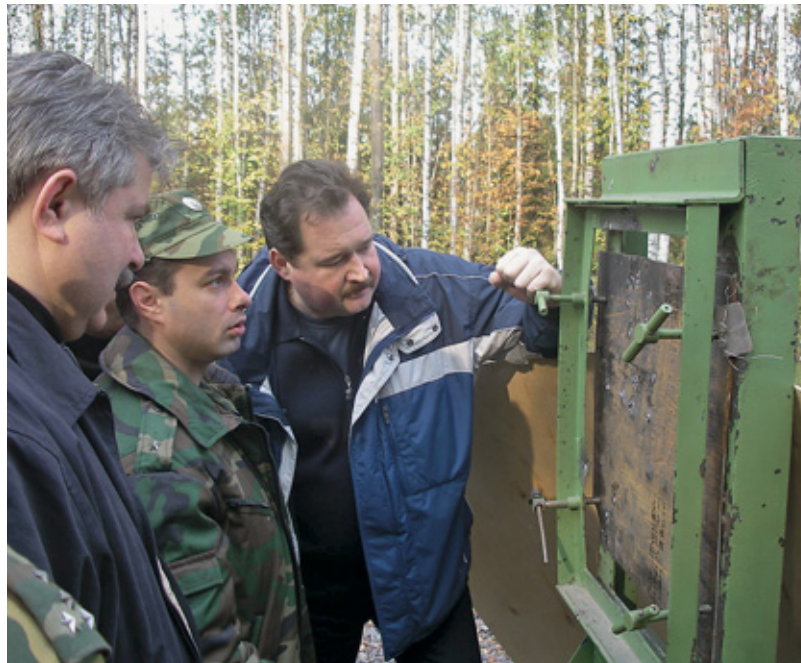
В испытаниях оружия и боеприпасов не бывает мелочей – обратите внимание на пломбу бронеплиты, которая используется для контроля параметров бронепробиваемости патронов
