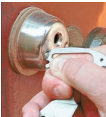
Нож может заменить обычную и крестовую отвёртки, что позволяет при отсутствии специального инструмента работать с винтами и шурупами. Прочность ножа достаточна для того, чтобы использовать его в качестве гвоздодёра
