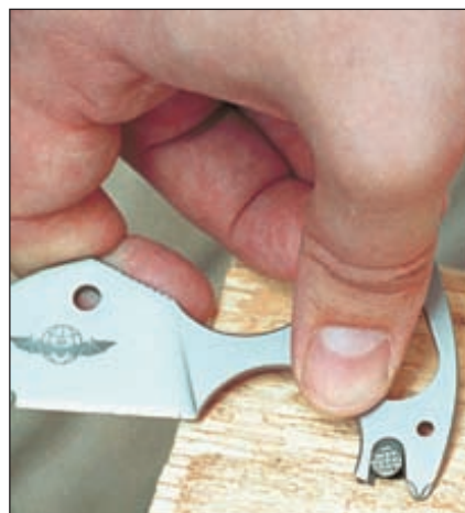
Нож может заменить обычную и крестовую отвёртки, что позволяет при отсутствии специального инструмента работать с винтами и шурупами. Прочность ножа достаточна для того, чтобы использовать его в качестве гвоздодёра
