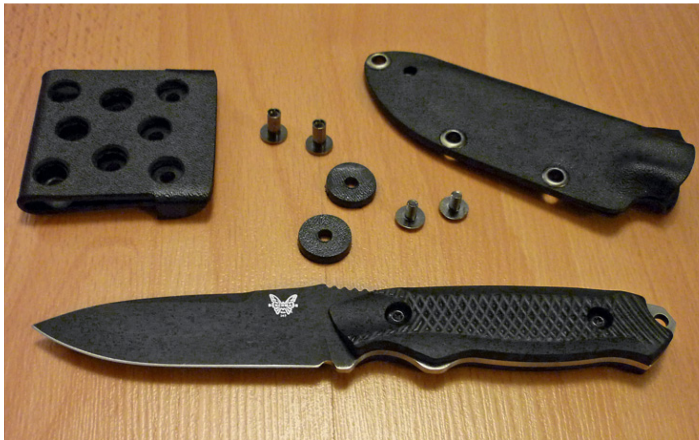
Ножны в разобранном виде: клипса, крепёжные винты с прокладками и собственно ножны. На фото уже доработанный нож, визуально его сразу можно отличить по сточенному упору подпальцевой выемки
