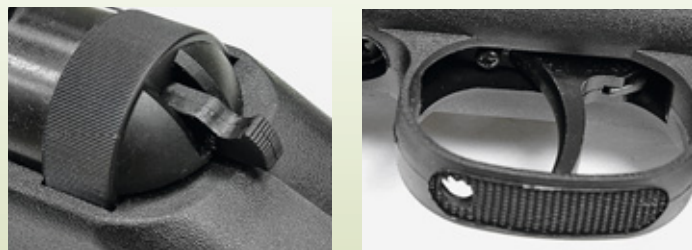
На фото слева – предохранитель винтовки во включенном положении. Доступ к винту регулировки свободного хода спускового крючка осуществляется через отверстие в спусковой скобе
