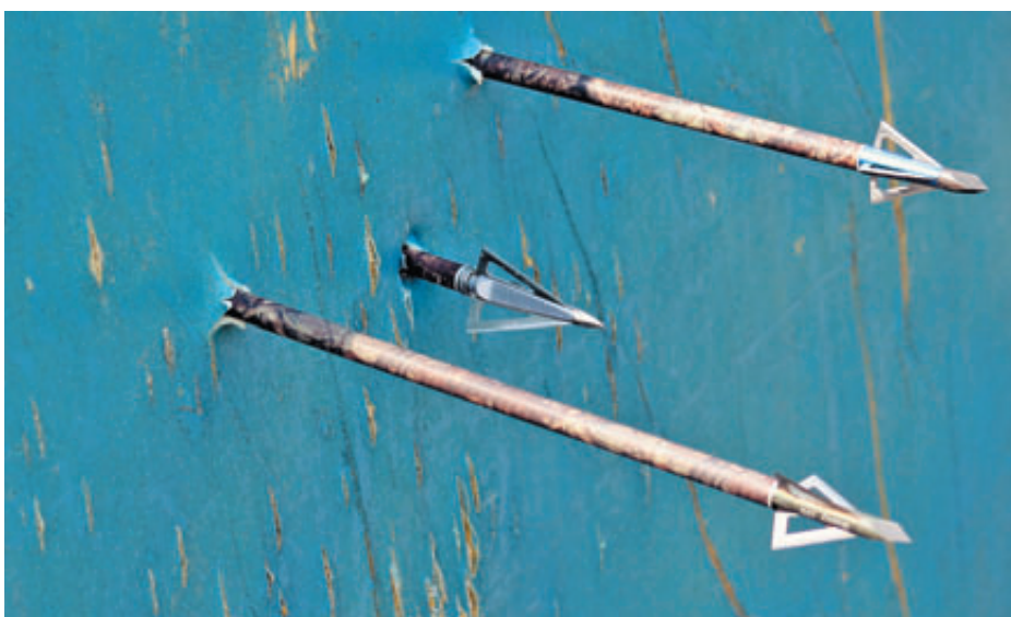
Результат эксперимента: из пяти стрел с разными наконечниками насквозь щит пробили только наконечники с лезвиями
