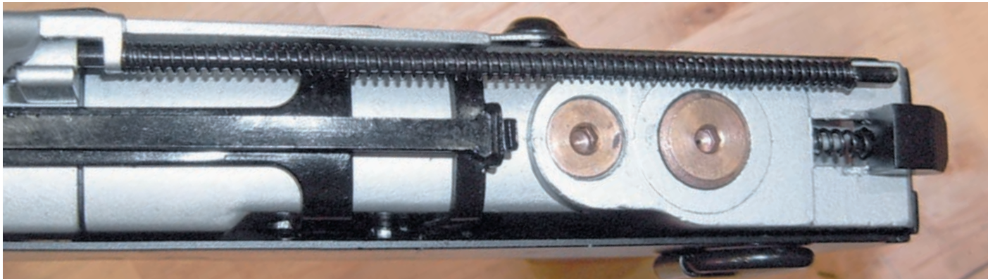
Винты регулировки темпа стрельбы и скорости вылета шара
