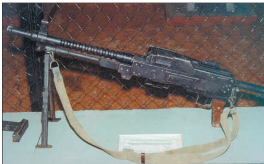
7,62-мм пулемёт, переделанный из штатного танкового пулемёта ПКТ. На оружии появились прицельные приспособления, приклад и спусковой механизм, позволяющие использовать пулемёт как пехотное оружие
