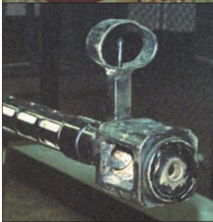
Крупнокалиберный пулемёт, переделанный из КПВТ. На образце появились прицельная планка и дульный тормоз с мушкой и намушником
