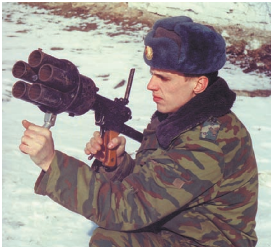
Пятиствольный ручной гранатомёт, использующий выстрелы штатных армейских подствольных гранатомётов ГП-25/30
