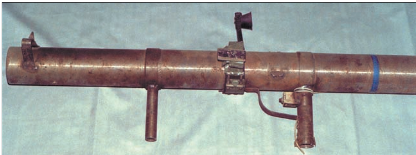
Пусковая установка для запуска неуправляемых авиационных ракет. На пусковую трубу установлены прицельные приспособления от реактивного пехотного огнемёта «Шмель»
