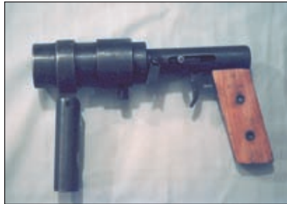
Гранатомёты пистолетного типа под выстрел ВОГ-25 представляют собой простейшую конструкцию. Скорее всего они выпускались серийно, так как на образцах, хранящихся в музее имеются серийные номера
