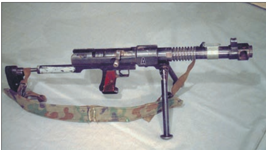
30-мм однозарядный гранатомёт спроектированный под боеприпас к армейскому гранатомёту АГС-17
