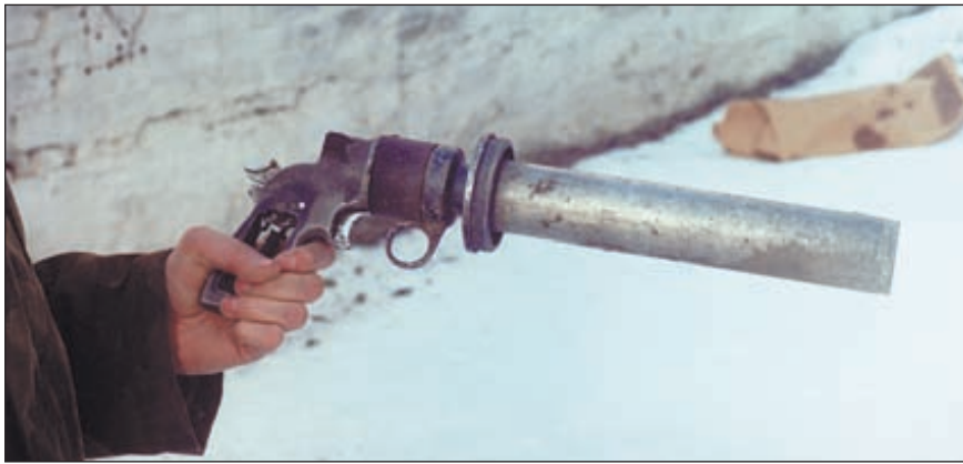
Гранатомёты пистолетного типа под выстрел ВОГ-25 представляют собой простейшую конструкцию. Скорее всего они выпускались серийно, так как на образцах, хранящихся в музее имеются серийные номера
