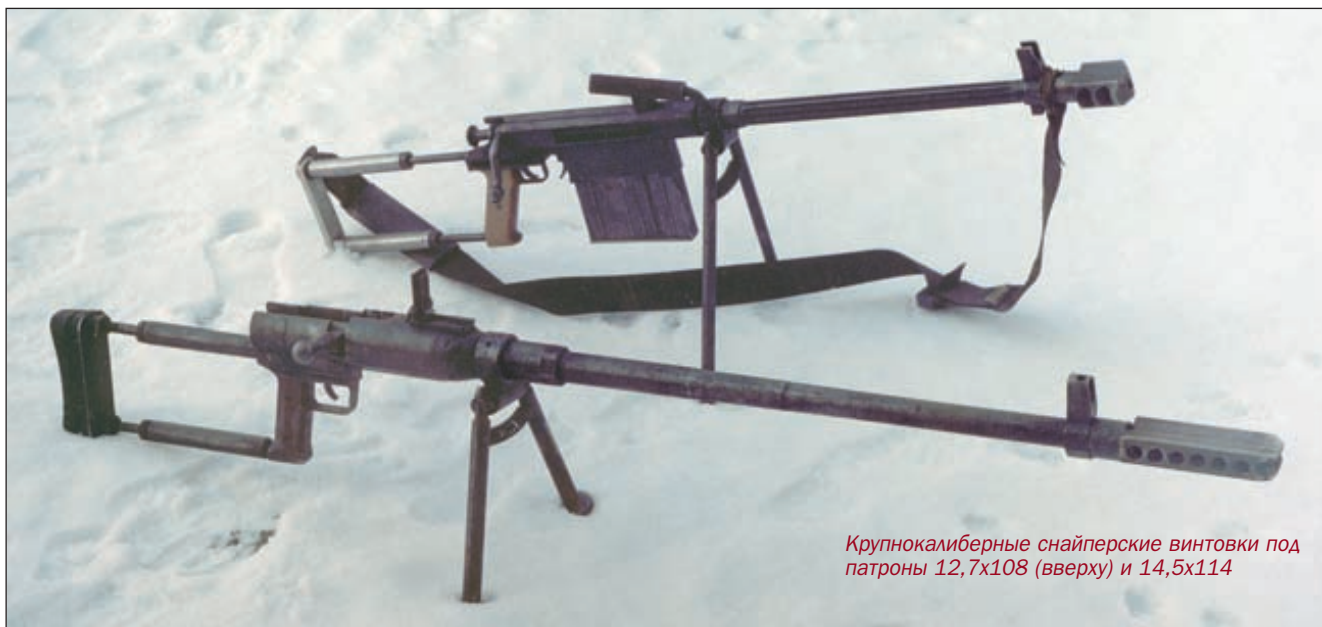
Питание патронами 12,7-мм винтовки осуществляется из коробчатого магазина вместимостью 5 патронов. Затвор винтовки продольно-скользящий. Прицельное приспособление оснащено перекидным, двухпозиционным целиком
