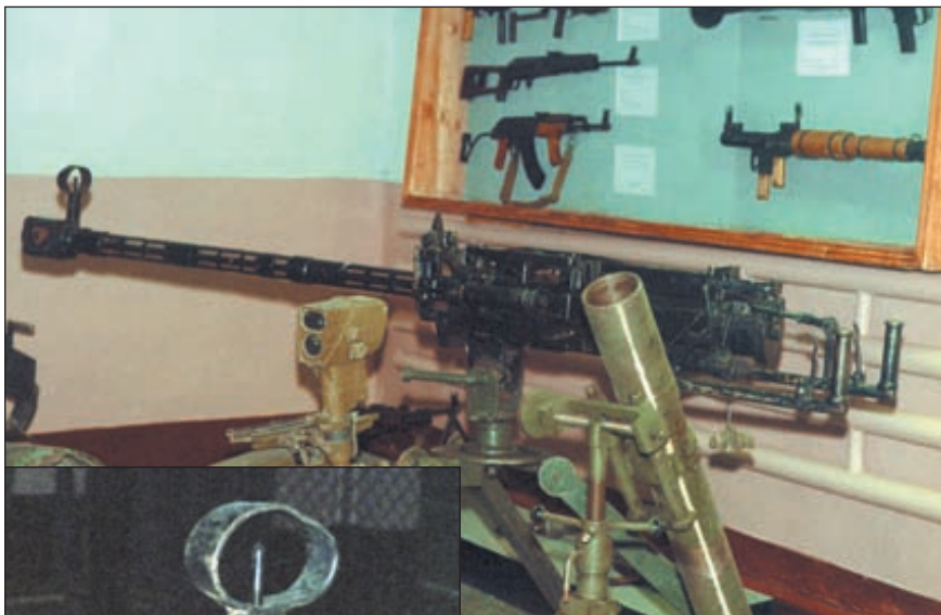
Крупнокалиберный пулемёт, переделанный из КПВТ. На образце появились прицельная планка и дульный тормоз с мушкой и намушником
