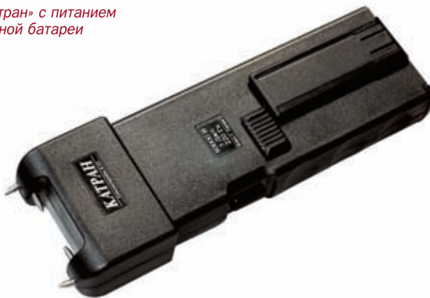
ЭШУ «Катран» с питанием от Ni-Cd аккумуляторной батареи с присоединённым зарядным устройством. Справа от клавиши предохранителя виден индикатор готовности к работе
