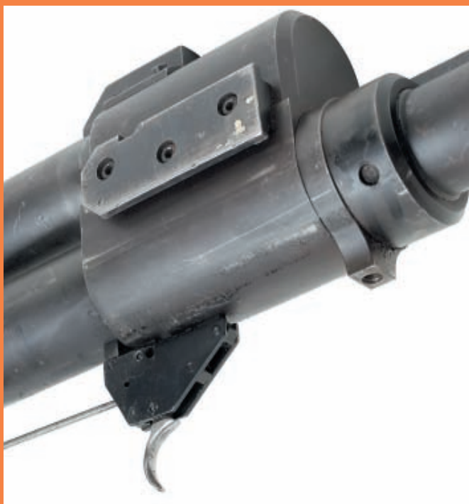
Спусковой крючок с тягой; кронштейн ночного прицела
