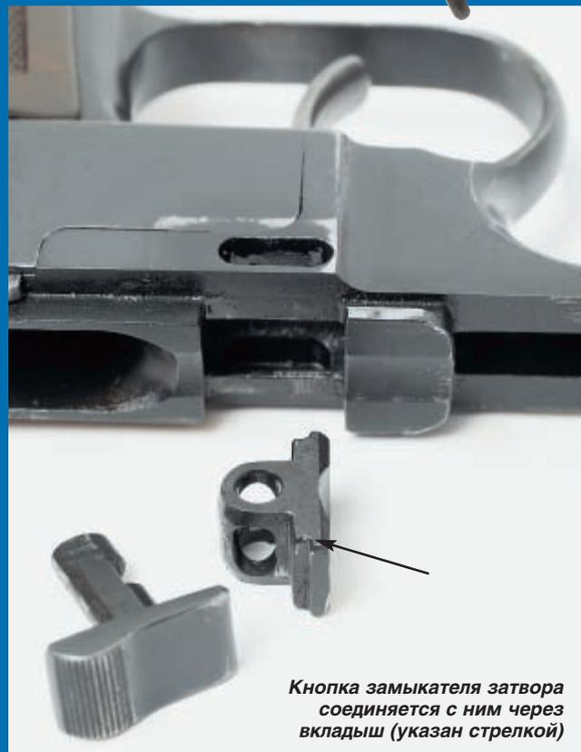
**Кнопка замыкателя затвора соединяется с ним через вкладыш (указан стрелкой)**
