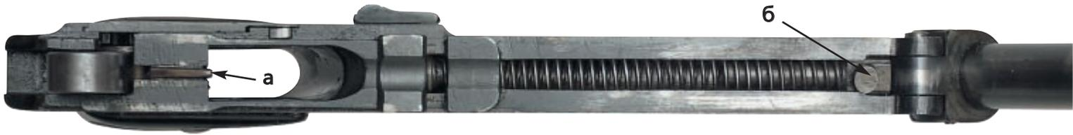
*Вид сверху на рамку пистолета. Хорошо различим возвратный механизм и центрально расположенный отражатель (а). Толкатель возвратного механизма соединяется с затвором выступом (б)*
