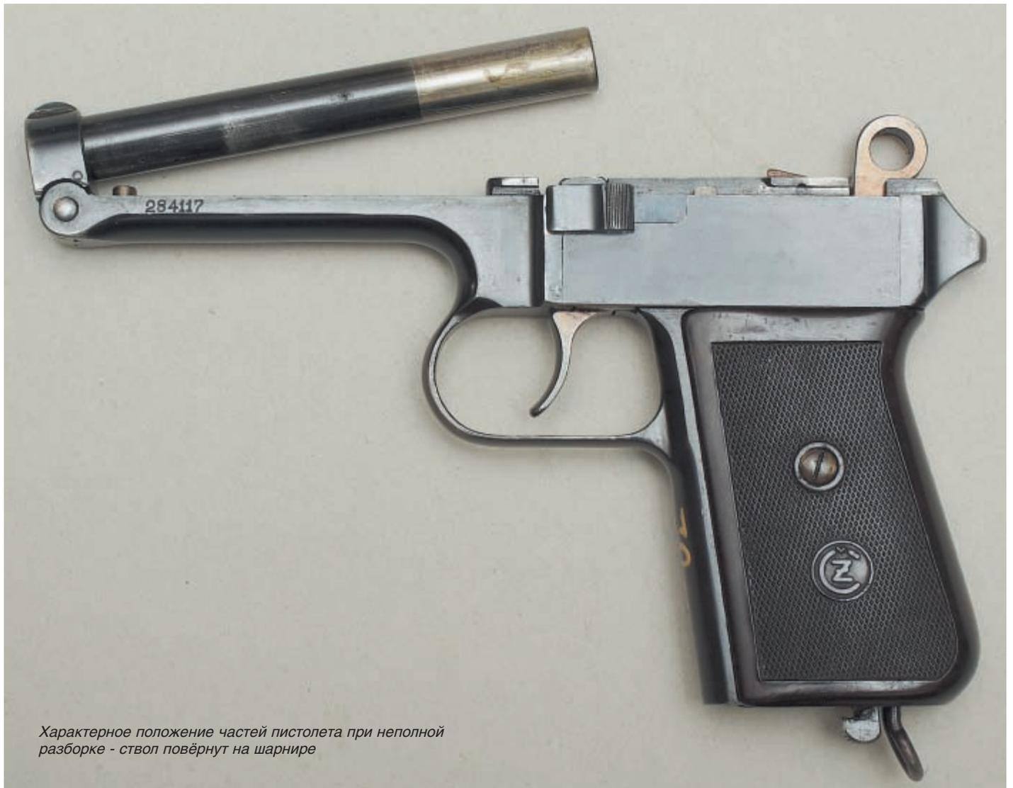
*Характерное положение частей пистолета при неполной разборке - ствол повёрнут на шарнире*
