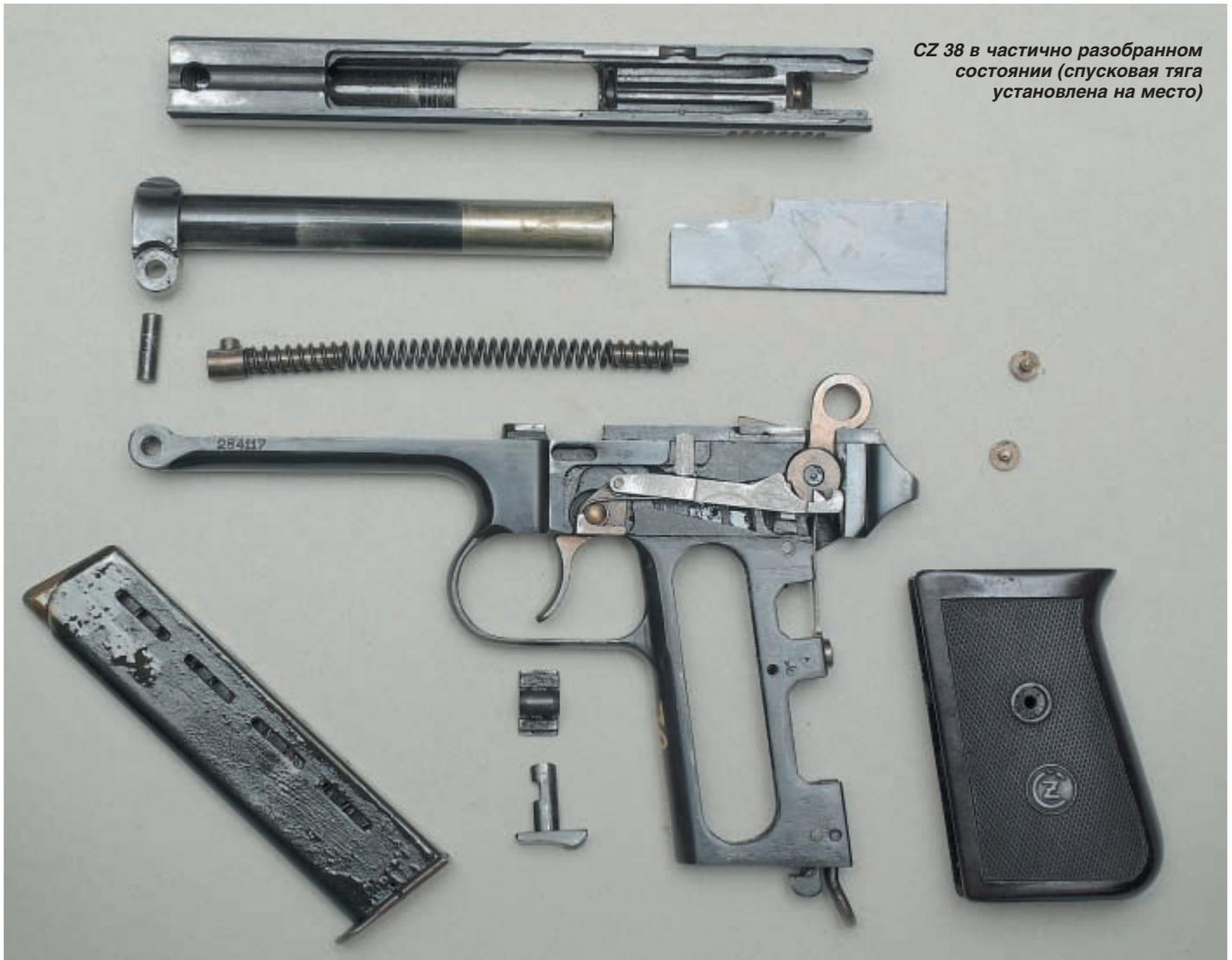
**CZ 38 в частично разобранном состоянии (спусковая тяга установлена на место)**
