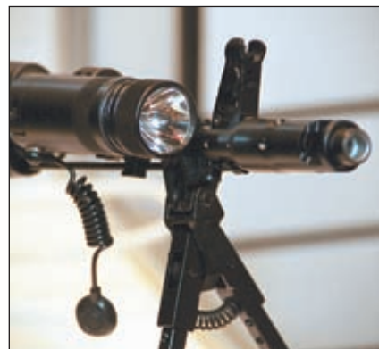
Москва 2001. Тактический фонарь фирмы «ЭСТ» и складывающаяся сошка предприятия «Продиз», установленные на автомат АК74М
