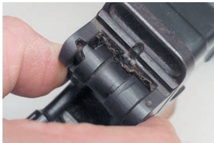
Для перевода плечевого упора в походное положение его шарнир расфиксируется боковым нажатием
