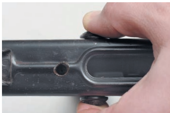
Отведение затвора в заднее положение осуществляется двумя пальцами
