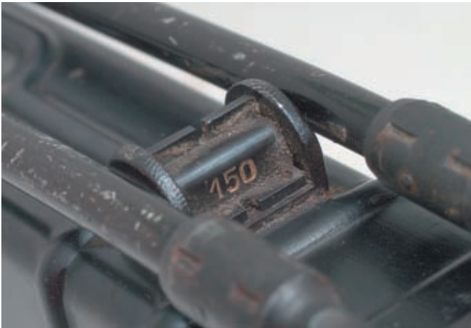
Перекидной целик имеет две установки – 75 и 150 м
