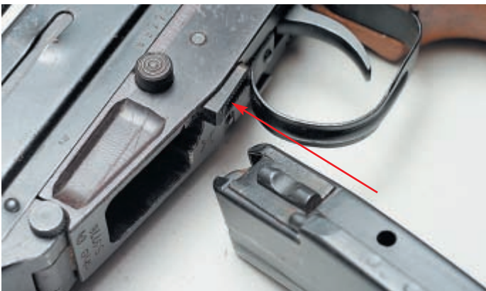
Стрелкой указана кнопка автоматической затворной задержки
